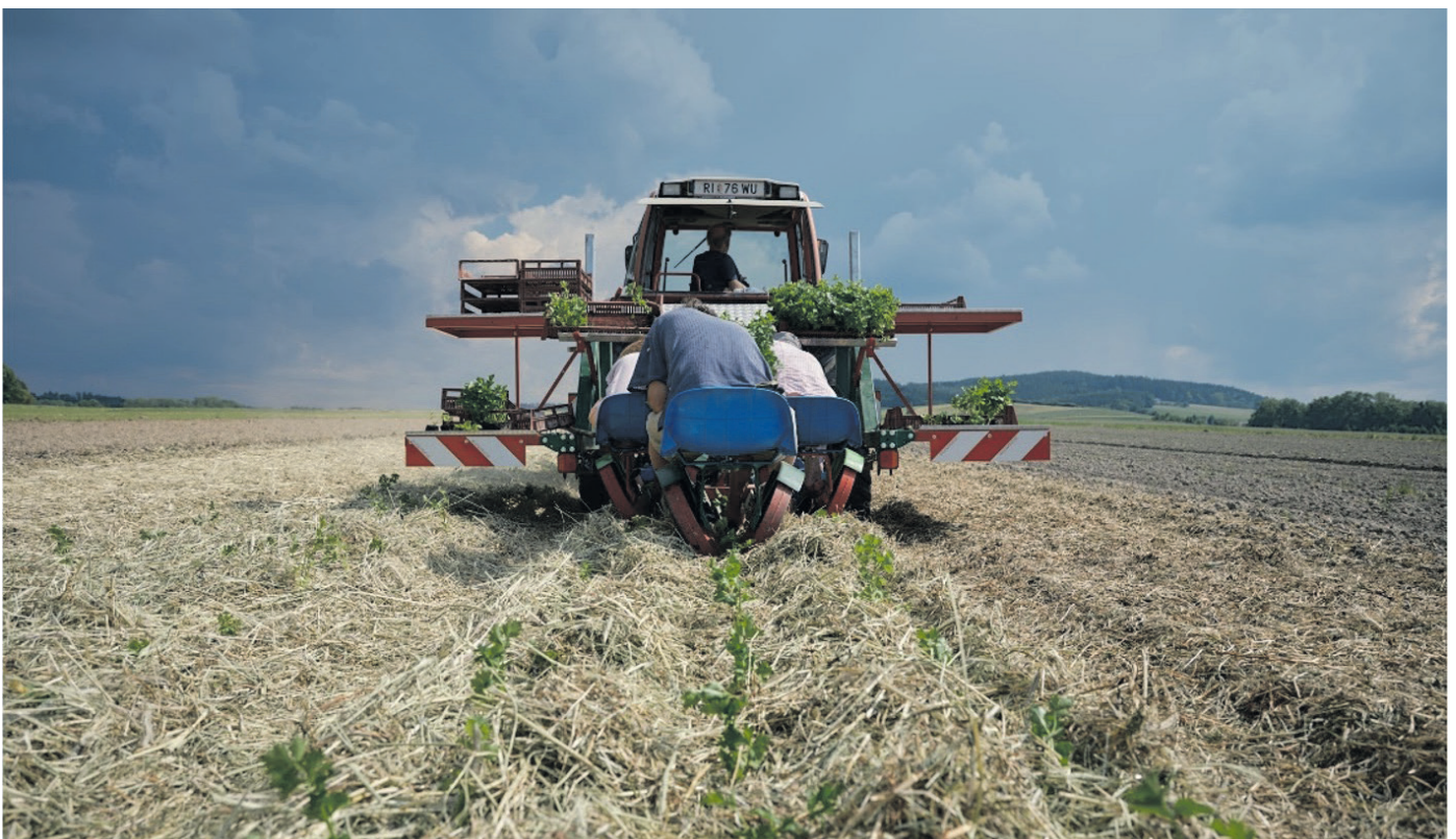
Setzen von Sellerie Jungpflanzen in Mulchschicht mit Mulchtec Planter.
